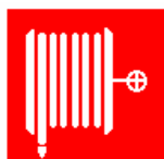
Manguera para incendios
