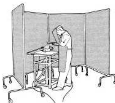
Fig. 4: Mampara de separación
